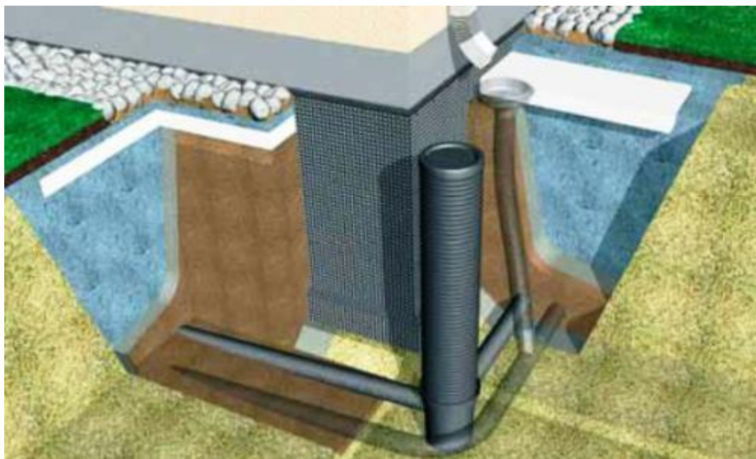
Рис.3. Разрез по фундаменту с устройством дренажной системы и организацией удаления дождевой и талой воды с кровли.
