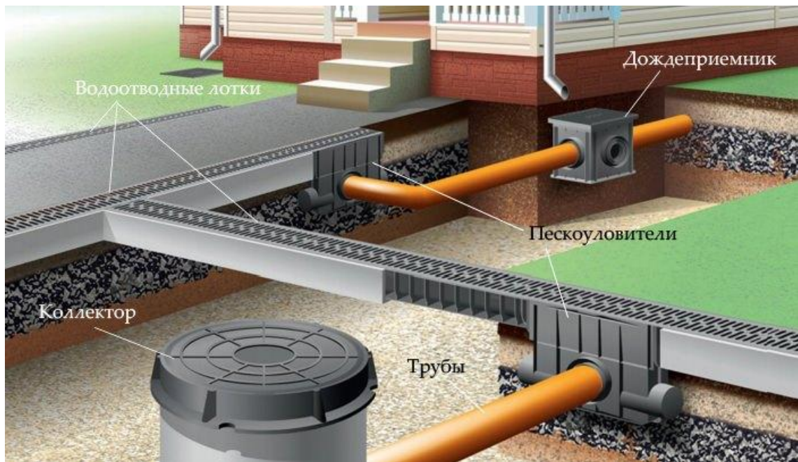
Рис. 1. Организация наружного водостока на территории храмового комплекса.
